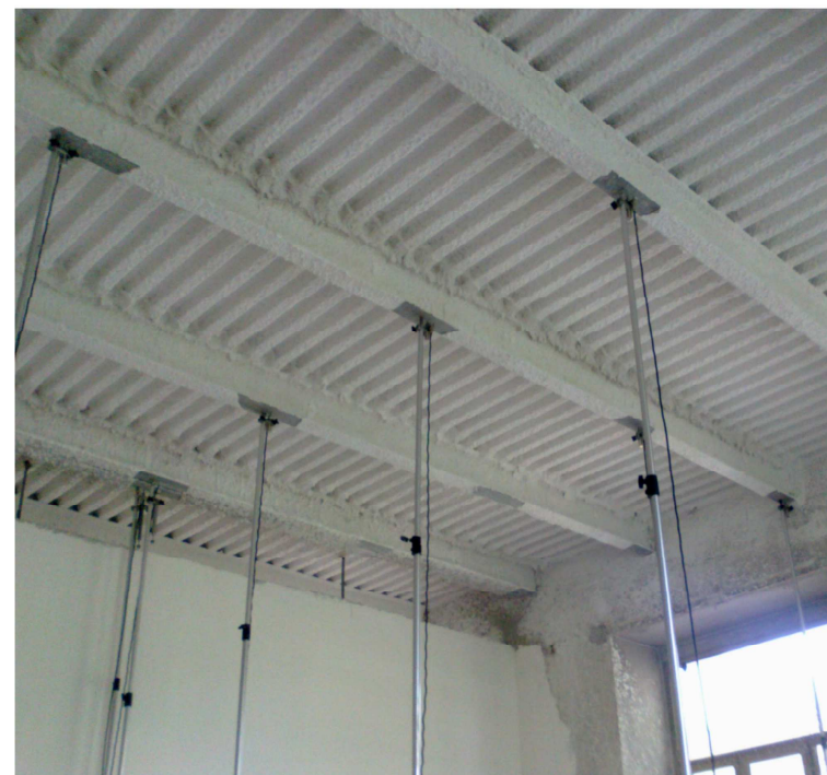
la prova di carico: il sistema di comparatori applicati all'intradosso del campo del solaio di prova
