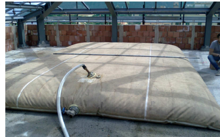
la prova di carico del solaio
