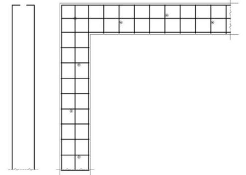
disposizione planimetrica delle chiodature verticali nel cordolo
