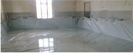
applicazione del carico per allagamento di un intero campo di solaio
